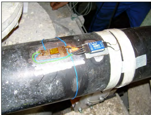
Mesure du couple à l'aide de télémétrie
